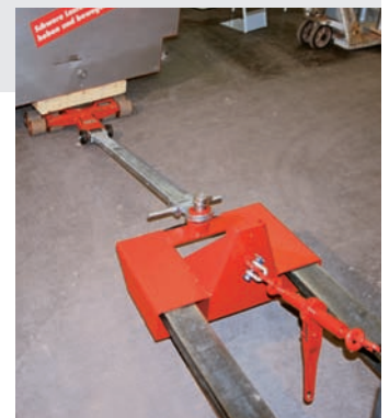
Вилочный прицеп JRH 3 в работе Forklift hitch JRH 3 in action
