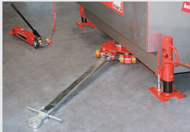
Применение в качестве управляемой тележки
