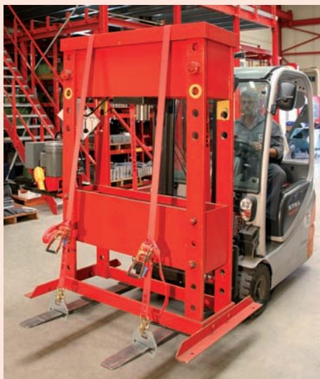
Фиксация груза с помощью захватов и ремней.
